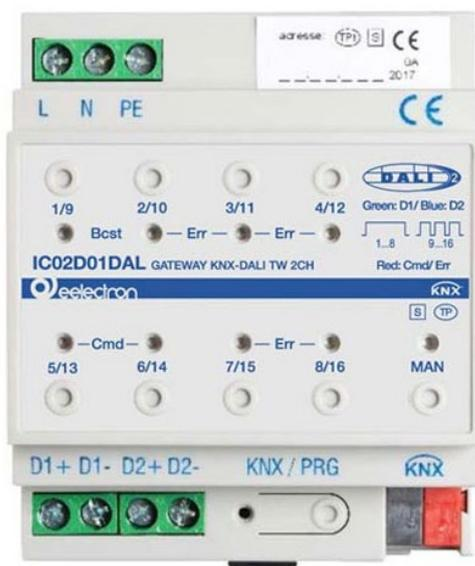
Se puede acceder a los pulsadores y LEDs sin tener que quitar la cubierta. Durante el funcionamiento del bus KNX y en ausencia de errores, los 9 LEDs se apagan. Si la puerta de enlace detecta un error (por ejemplo, una lámpara defectuosa o un fallo KNX), solo se encenderá el LED del pulsador manual que se ilumina en rojo y parpadea rápidamente. Durante la programación (p. ej. durante la instalación), todos los LEDs se encienden en rojo y parpadean lentamente.
