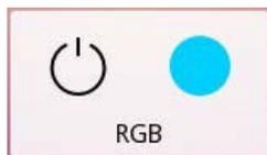
La funzione del pulsante di azione viene configurata tramite il parametro funzione Pulsante sinistro: Disattiva tutti i canali (imposta tutti i canali su 0%) o passa dalla disattivazione di tutti i canali al richiamo del colore selezionato in precedenza.
