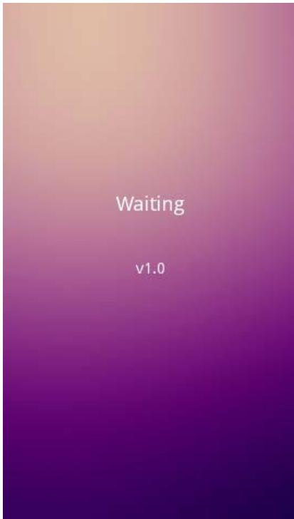
La pagina di sincronizzazione rimane fino a quando il dispositivo non viene programmato con i dati dell'applicazione da ETS. Questa pagina viene visualizzata anche se il bus KNX è scollegato o durante la riprogrammazione del dispositivo.
