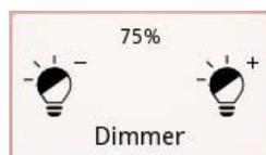
Il valore attuale dell'intensità luminosa viene visualizzato in percentuale (0...100%) e viene aggiornato ogni volta che viene ricevuto un nuovo valore tramite l'oggetto di comunicazione Indicatore di livello di regolazione.
