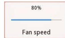
Inoltre, quando si preme l'area del componente, si aprirà una finestra contenente una barra di regolazione interattiva che consente all'utente di selezionare i valori da inviare al bus.
