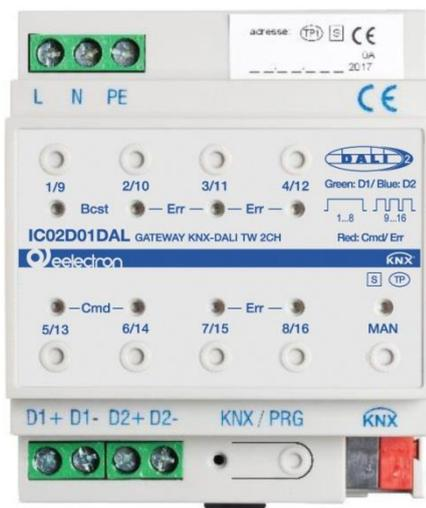
I pulsanti e i LED sono accessibili senza necessità di rimuovere il coperchio. Durante l'uso del bus KNX e in assenza di errori, tutti i 9 LED sono spenti. Se il gateway rileva un errore (ad es. una lampada guasta o un guasto KNX), si accende e lampeggia rapidamente solo il LED rosso sul pulsante Man. Durante la programmazione (ad es. durante l'installazione), si accendono e lampeggiano lentamente tutti i LED rossi.
