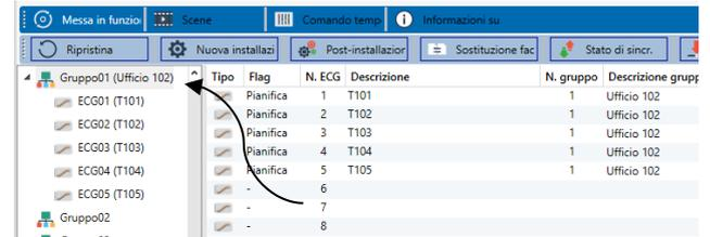
Una volta assegnato un ECG a un gruppo tramite il trascinamento e rilascio, viene visualizzato automaticamente il numero del gruppo nel campo "Numero gruppo" della tabella di configurazione ECG.
