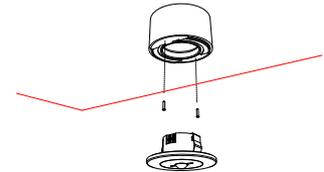
Installazione a vista con accessorio di montaggio per superficie
