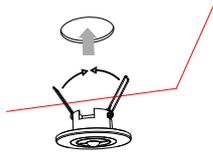
Incasso a controsoffitto. La stabilità è garantita dai fermagli a molla, nascosti nel montaggio a soffitto.
