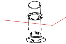
Installazione mediante un telaio per scatole da incasso, installato a soffitto
