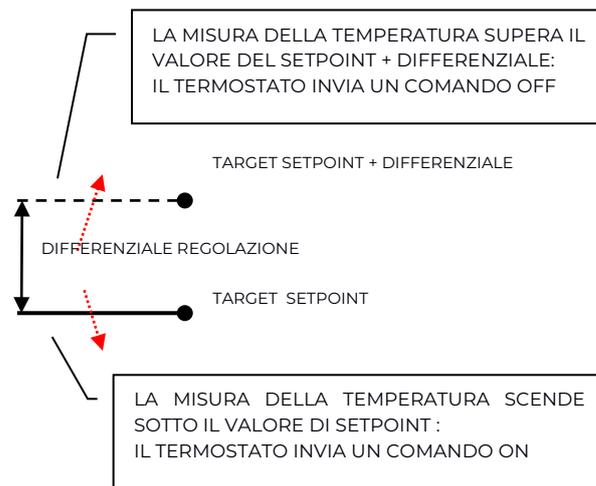
L'immagine che segue propone invece il funzionamento del controllo on/off in raffrescamento.
