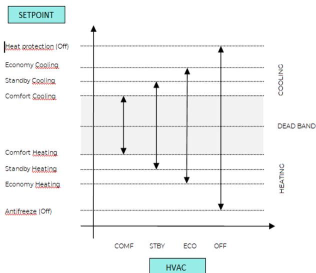
È possibile impostare il setpoint di comfort come centro della banda morta tramite il relativo parametro; il valore di comfort risulta comune alla modalità di riscaldamento e di raffreddamento.
