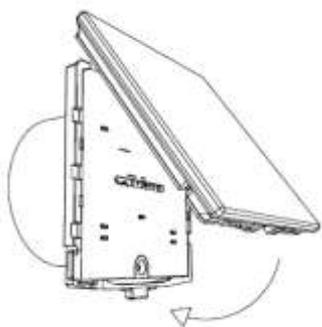
4 Per rimuovere la cover, spingere il perno sul fondo del coperchio di plastica, quindi rimuovere prima la parte inferiore e poi la parte superiore.
