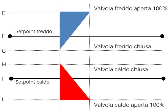
Questo permette di regolare l'apertura e la chiusura della valvola addizionale in modo indipendente dalla regolazione delle velocità (per esempio una volta superato il setpoint è possibile fare una azione di mantenimento tenendo ancora la valvola aperta senza attivare le velocità)
