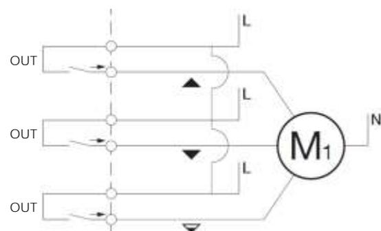
Oltre alle uscite che attivano i circuiti di salita [▲] e discesa [▼] è usata una terza uscita per gestire il
