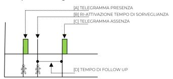
Nel modulo presenza viene inviato il telegramma di presenza (se abilitato) nel momento in cui il sensore rileva la presenza [A]; il dispositivo attende lo scadere del tempo di sorveglianza per inviare il telegramma di assenza (se abilitato) [C]; qualora durante il tempo di sorveglianza venga rilevato un nuovo movimento [B] il conteggio del tempo riparte. Il telegramma di assenza viene inviato solo quando il tempo di sorveglianza si esaurisce senza che venga rilevato alcun movimento [D]
