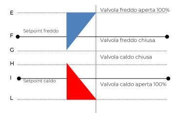
Questo permette di regolare l'apertura e la chiusura della valvola addizionale in modo indipendente dalla regolazione delle velocità (per esempio una volta superato il setpoint è possibile fare una azione di mantenimento tenendo ancora la valvola aperta senza attivare le velocità)
