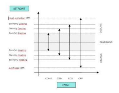
E' possibile impostare il setpoint di comfort come centro della banda morta tramite il relativo parametro; il valore di comfort risulta comune alla modalità di riscaldamento e di raffrescamento.
