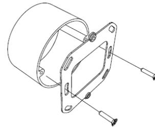
2 Collegare il cavo KNX al dispositivo e fissarlo al telaio di metallo con le apposite viti incluse.
