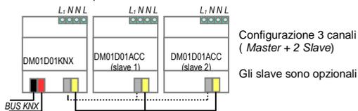
Il dispositivo DM01D01KNX può essere utilizzato in una delle seguenti configurazioni:
